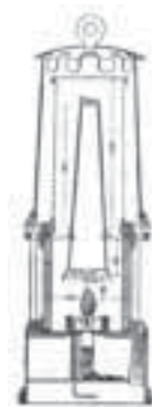
Lampe de sûreté modèle Mueseler XX e siècle. Lampes pour mines / Fabrique liégeoise de lampes de sûreté, 1912 (?). Fig. 1, p. 8. Coll. CLADIC.
