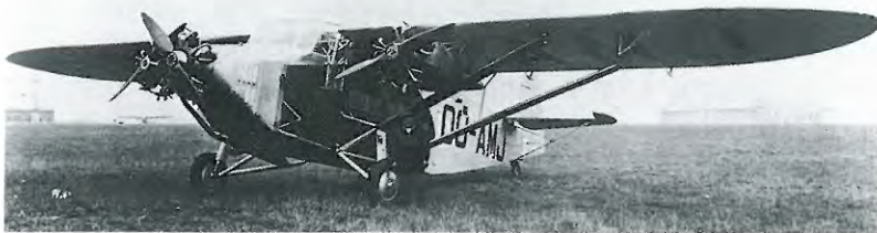
Le prototype du trimoteur SABCA S 12 (OO-AMJ) est sorti en 1931. Créé et construit comme avion de liaison et de transport pour les lignes intérieures congolaises, il pouvait embarquer quatre passagers (plus un pilote) et atteindre 170 km/h. Il ne connut pas de fabrication en série. (L'Aviation civile belge en images, p. 25).
