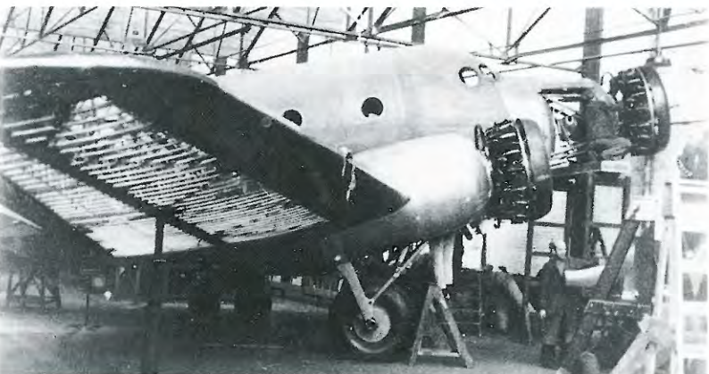
Le Renard R 35 (1937), un avion de haute altitude dans lequel vingt passagers pouvaient prendre place. Mis à part quelques parties (notamment les ailes recouvertes de toile renforcée) il était construit en métal. (L'Aviation civile belge en images, p. 34).
