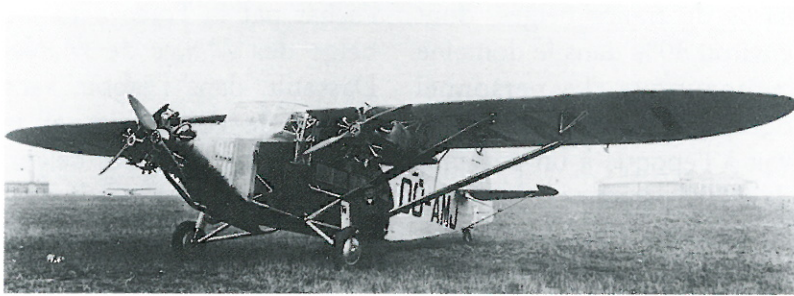
Le prototype du trimoteur SABCA S 12 (OO-AMJ) est sorti en 1931. Créé et construit comme avion de liaison et de transport pour les lignes intérieures congolaises, il pouvait embarquer quatre passagers (plus un pilote) et atteindre 170 km/h. Il ne connut pas de fabrication en série. (L'Aviation civile belge en images, p. 25).
