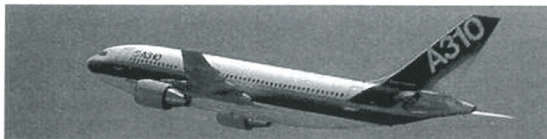
L'Airbus Industries A 310 possède un fuselage plus court que le A 300 et une aile de technologie plus avancée conçue par British Aerospace. (Chronique de l'aviation, p. 794).
