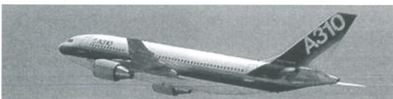
L' Airbus Industrie A 310 possède un fuselage plus court que le A 300 et une aile de technologie plus avancée conçue par British Aerospace . (Chronique de l'aviation, p. 794).
