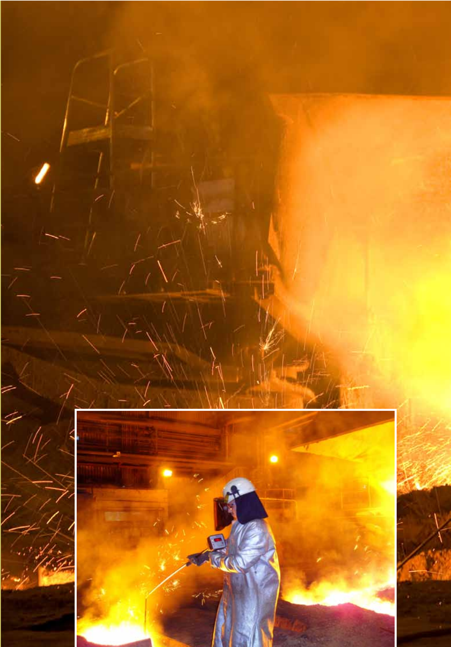
Haut fourniste mesurant la température de la fonte sur le plancher de coulée du haut fourneau B Cockerill à Ougrée, novembre 2007 © Ph. Tomsin
