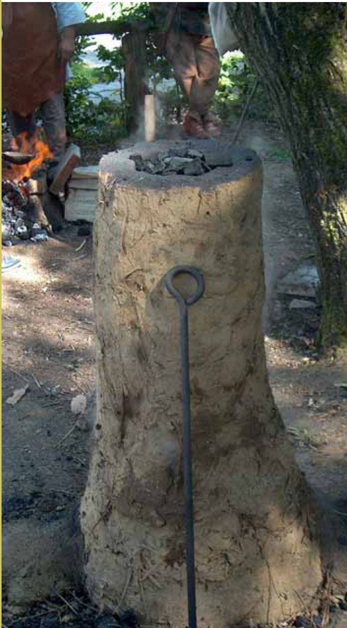
Reconstitution et expérimentation d'un bas fourneau gallo-romain. Archéosite d'Aubechies, août 2009 © Ph. Tomsin
